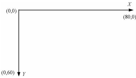
图5 摄像头图像坐标系
