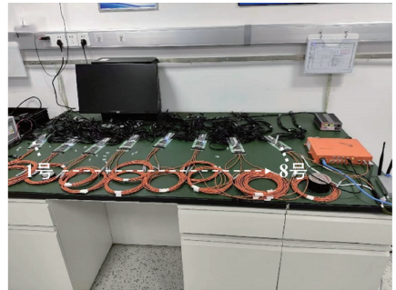
(a) 无线柔性测试系统中的数据采集部分 (a) The data acquisition part in the wireless flexure test system
